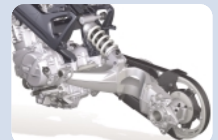
La suspensión trasera se puede regular para viajar más seguro cuando hay más peso.
