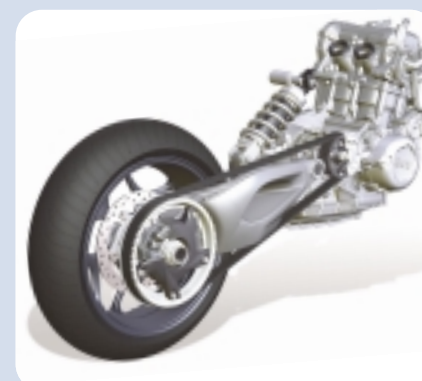
La tracción se realiza a través de una correa dentada. Es mucho más silenciosa y requiere menos mantenimiento que las cadenas.
