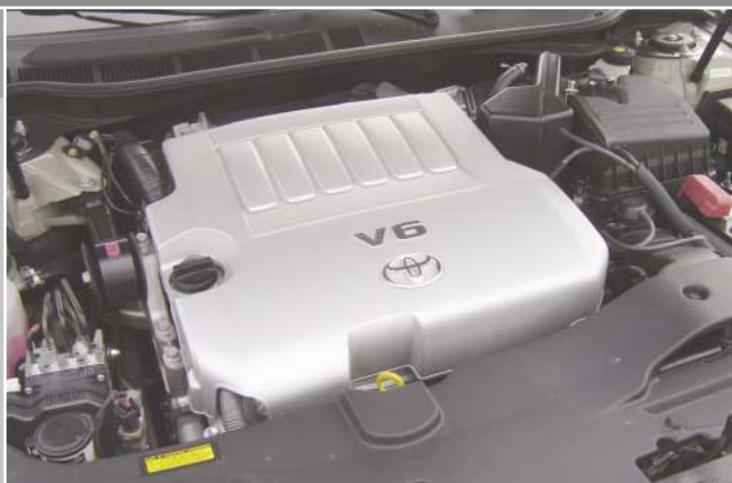
Motor V6 de 3.5 litros y 277 CV.
