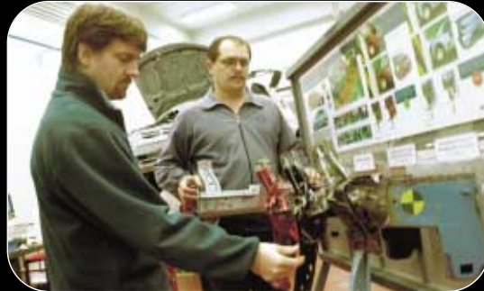
Maqueta de deformación de larguero de una carrocería autoportante.
