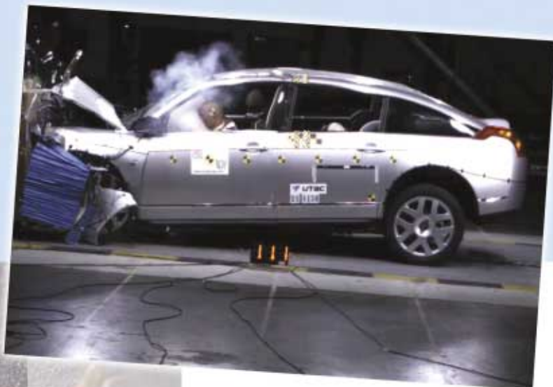
■ Crash test delantero de alta velocidad realizado por EuroNCAP, en el que el Citroën C6 obtuvo la máxima puntuación de 5 estrellas y 34 puntos de un máximo de 37 posibles.
