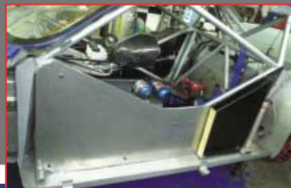
Plancha de aluminio para proteger al piloto ante un impacto lateral.
