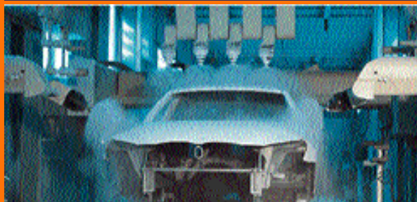
2. APLICACION DE PINTURA BASE
