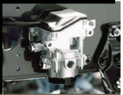
EBS (sistema electrónico de frenado): La electrónica reacciona con gran rapidez al frenar y proporciona una distancia de frenado muy corta. Los discos de freno tienen una fijación exclusiva que permite su expansión simétrica en caso de calentamiento. Ello alarga la duración y mantiene los mismos niveles altos de fricción y efecto frenante aún a temperaturas muy altas
