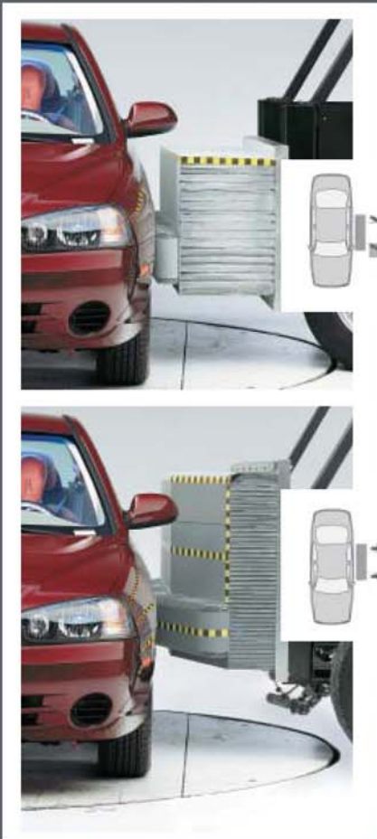
Los ensayos de Crash test laterales se realizan con diferentes barreras
