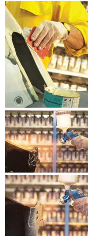
Impresión de relleno Promotor de adherencia masillado
