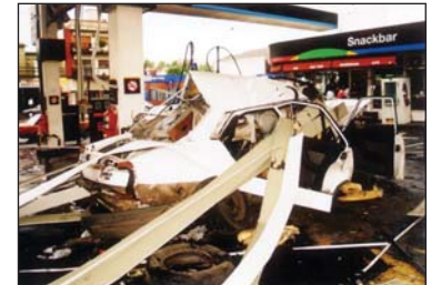
Explosión durante carga de GNC.
