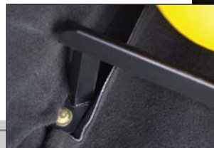
Anclaje de la cuna al piso.
