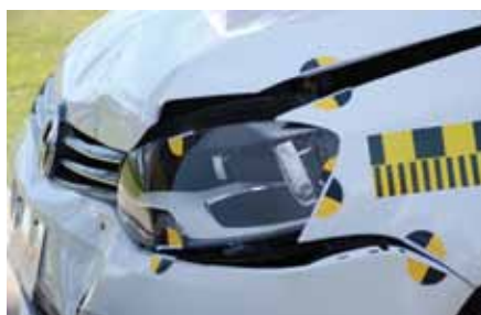
| Alto impacto. Los daños exteriores fueron superiores en la versión 2010.
